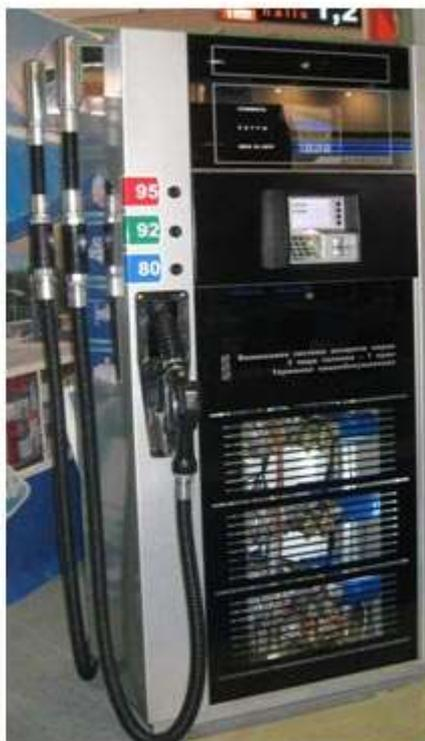
Первые попытки сделать ТРК с балансовой системой возврата паров, заключающиеся в условном и ненадежном уплотнении крана раздаточного на горловине бензобака и применение канала возврата ПВС, состоящего из шланга малого проходного сечения, располагавшегося внутри рукава подающего бензин, потерпели неудачу из-за большого гидравлического сопротивления по перемещению ПВС от бака автомобиля до присоединительного трубопровода ПВС от резервуара.
