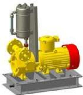
Электронасос КМВГ 40-25-150Ес двойным торцевым уплотнением и системой охлаждения сосуд-бачек - консольный моноблочный вихревой газовый одноступенчатый, предназначен для перекачивания сжиженных углеводородных газов и других маловязких летучих низкокипящих жидкостей температурой от - 40°С до + 50°С, вязкостью до 0,55х10-6м2/с (0,55сСт), плотностью до 600 кг/м3.
